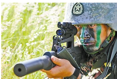
QCW05冲锋枪上安装的Y/MAL-05激光指示器和2倍瞄准镜的一体瞄准装置
